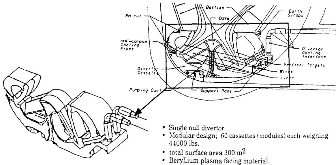
**Fig. A-4. The ITER Divertor**
