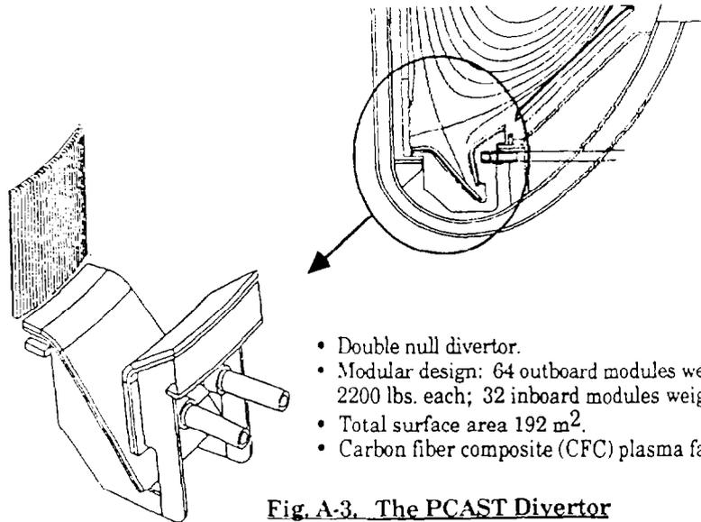
**Fig. A-3. The PCAST Divertor**
